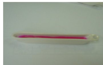
Fig. 3 JIS 磁製ボートと液体試料
