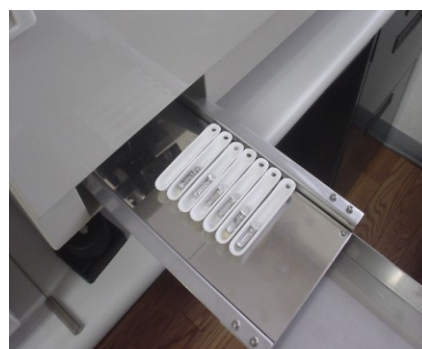
Fig. 2 燃焼・回収後の試料ポート
